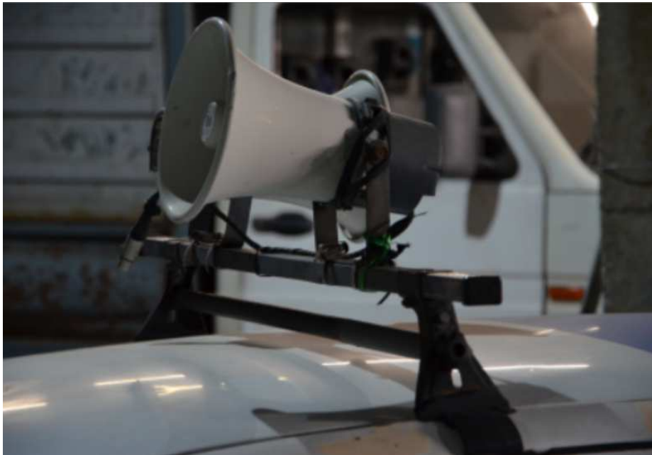
FOTOGRAFIA 13 Detalle de altavoz instalado en vehículo
